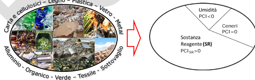
Figura 4.3: Passaggio concettuale dalla caratterizzazione merceologica del rifiuto alla caratterizzazione per finalità energetiche (o caratterizzazione "combustiva").
